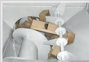
Шнековый компактор отличается высокой надёжностью и низким уровнем шума в сравнении с традиционными пресс-компакторами.
