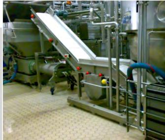
Выжимные прессы используются там, где речь идёт об удалении жидкости из волокнистых материалов. Отжим материала необходим для снижения транспортных расходов. Отжим материала дает возможность для дальнейшей его утилизации путем сжигания или захоронения.
