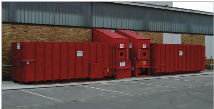
Непрерывно работающий шнек на односторонних горизонтальных опорах сминает и разрывает отходы и продвигает через небольшое отверстие в контейнер, за счет чего можно добиться большей плотности сжатия мусора. Уровень наполнения – на 60% выше, чем в обычном пресс-компакторе. Заполненный контейнер отделяется от блока прессования и вывозится на полигон для захоронения.
