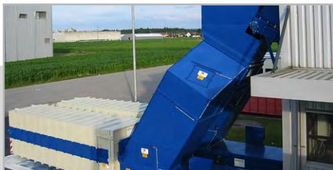
Вариант с хоппером, встроенным в стену и подающим желобом.
