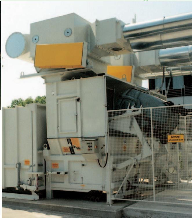
Тип: RHD под всасывающей установкой и подъёмно-опрокидывающим устройством
