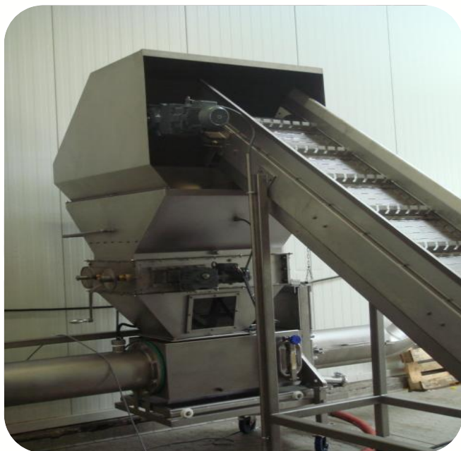
Бункер с защитой от разбрызгивания материала
