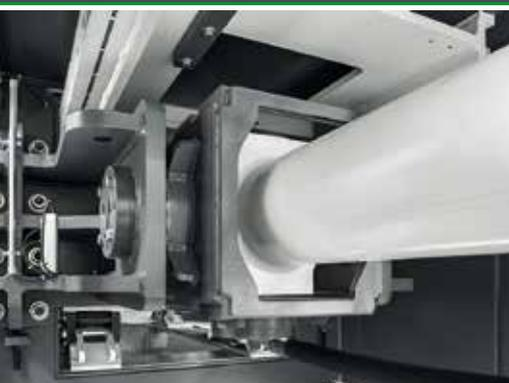
Шарнирное крепление основного цилиндра
