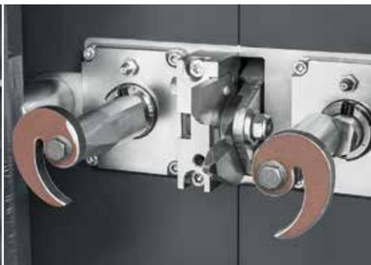
Механизм скручивания проволоки
