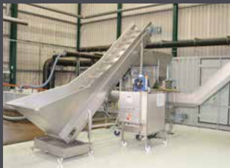
Универсальный утилизирующий пресс URP 300 на территории биогазового завода
